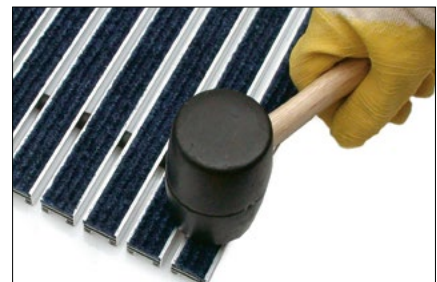
Neue Ripsstreifen mit Selbstklebeband in das Aluprofil einkleben und ggf. mit einem Gummihammer den Klebprozess verstärken.
