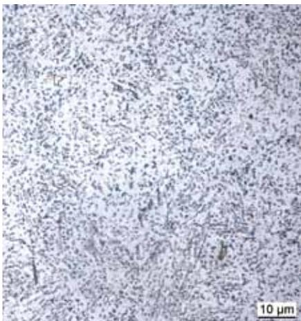
Bild / Fig. 7: Gefüge nach AC-Glühung
