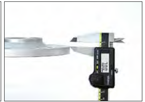
Darstellung Aussenfase 7x45°/Outer bevel 7x45°
