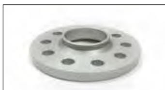
Artikel-Nr./Part-no. 2445651: Radnabenlänge max. 15 mm. Felgeninnenfase mind. 5x45° Wheel hub length max. 15 mm. Inner bavel 5x45°
