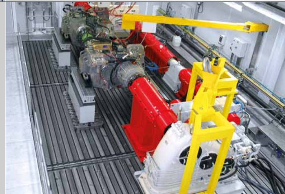
Großgetriebeprüfstand für Schiffsgetriebe 15.000 x 8.000 mm
