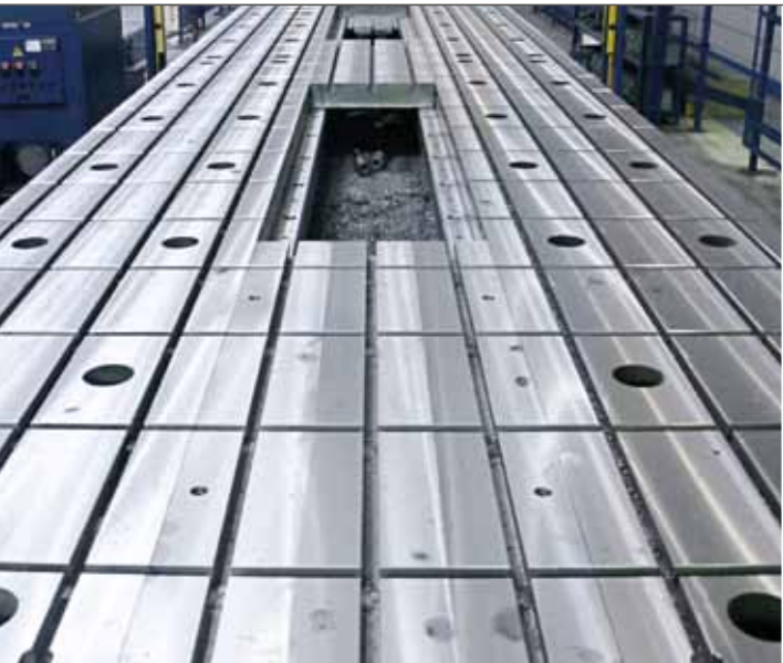
Maschinenbett einer Portalfräsmaschine mit Anbauflächen und Gewindebohrungen für Führungsleisten
