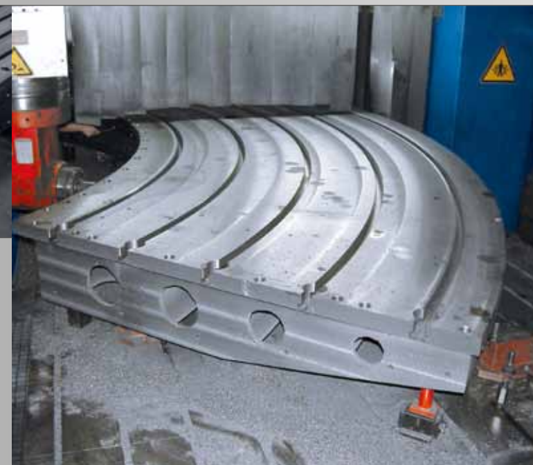
Segment eines Drehtisches mit 10.000 mm Durchmesser
