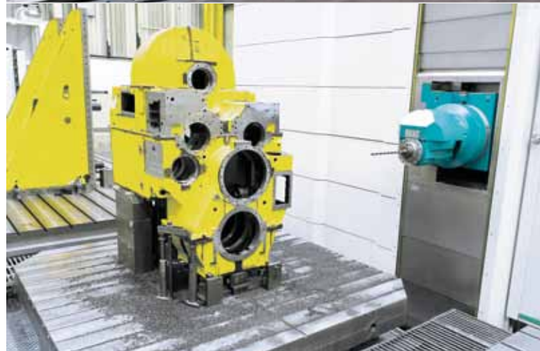
Großbearbeitungszentrum in Gantry-Bauweise mit STOLLE-Aufspannplattenfeld, 32.000 x 6.000 mm
