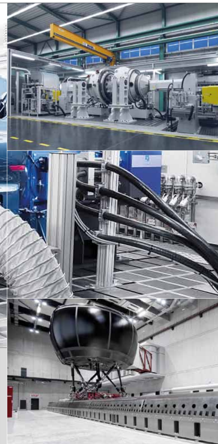
Fahrsimulator in Sindelfingen Luftlagerung des Hexapods auf einer Bettkonstruktion von 31.000 mm Länge
