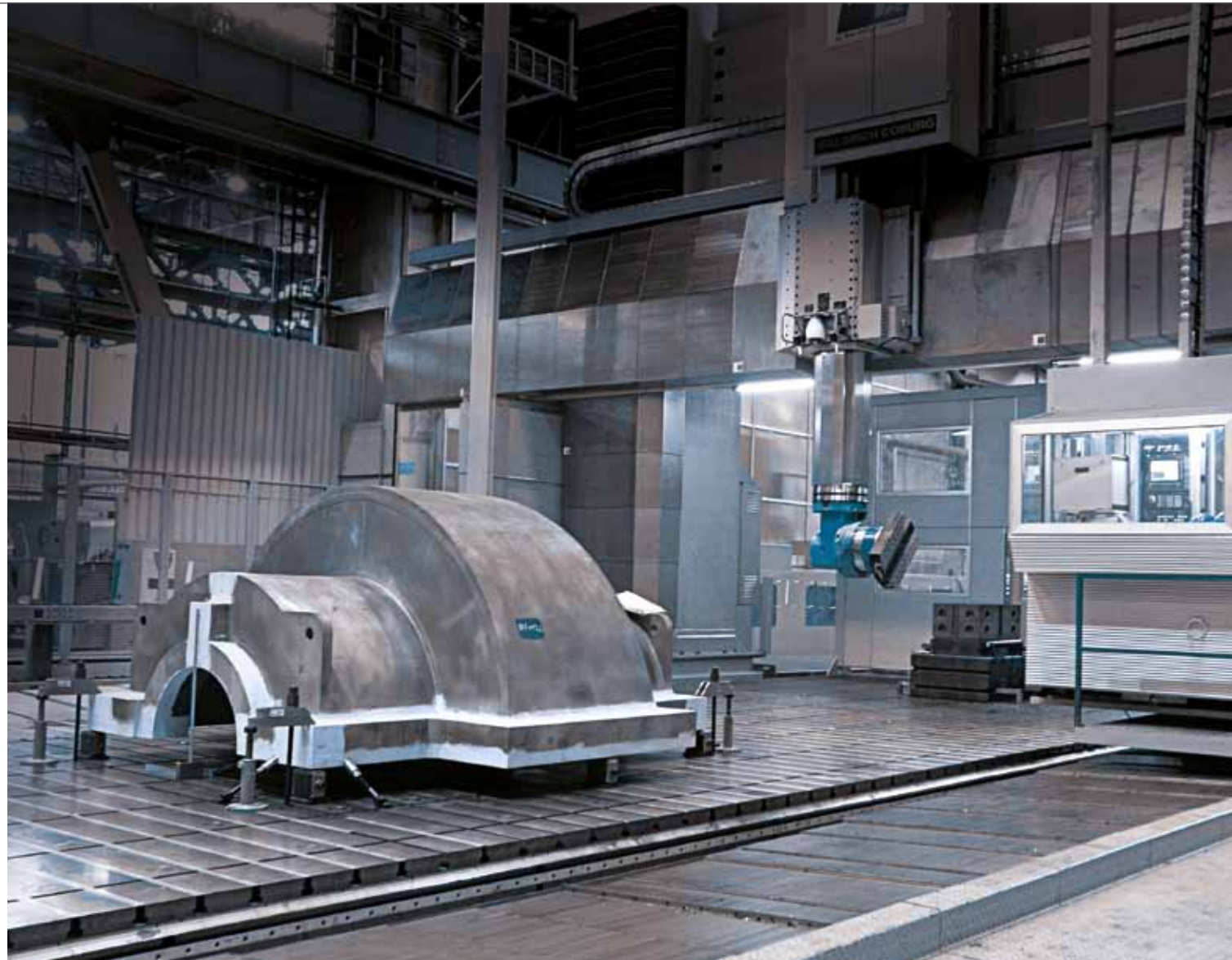
Großbearbeitungszentrum in Gantry-Bauweise mit STOLLE-Aufspannplattenfeld, 32.000 x 6.000 mm
