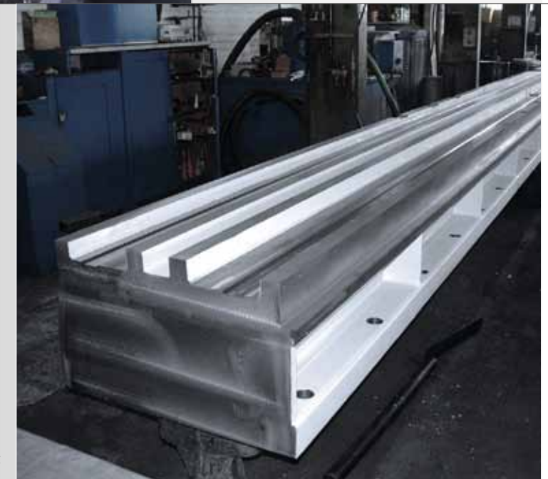
Maschinenbett zweiteilig in einer Spannung von 18.000 mm Länge bearbeitet
