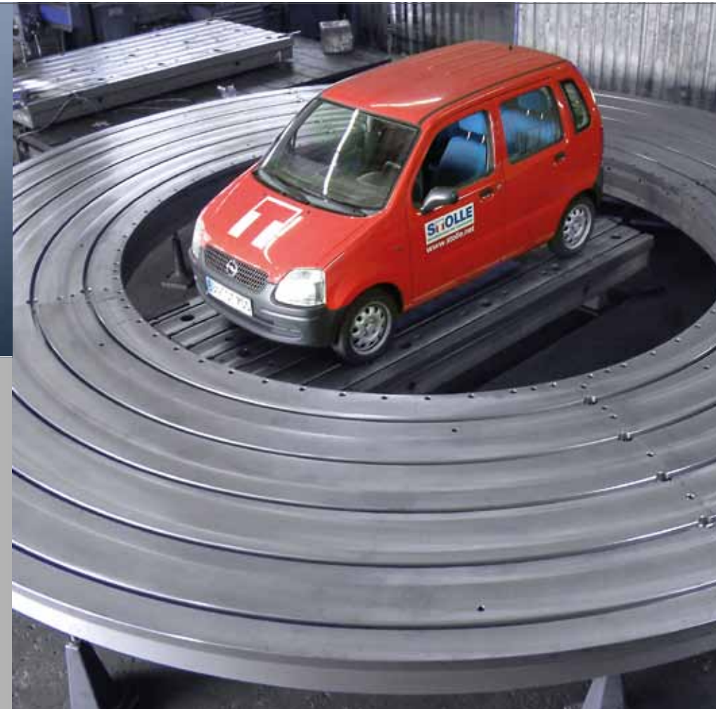
Drehtischverbreiterung für Schiffsschrauben- bearbeitung, Durchmesser 10.000 mm
