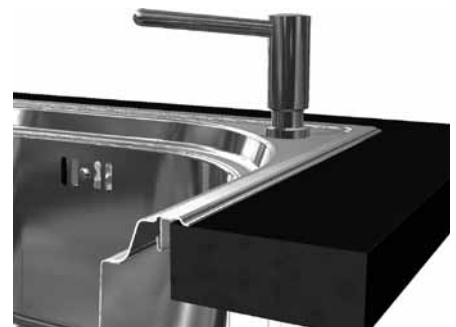
Einleger: Einlegespülen und -becken werden von oben in die Arbeitsplatte eingesetzt und weisen eine gewölbte Randausführung auf.
