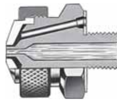
Düsenätze für Außenmischung und Unterdruck: Rundstrahlspritzbilder
