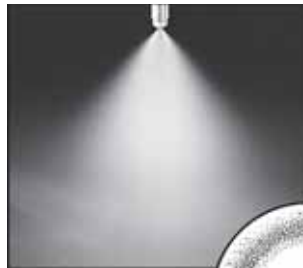
Spritzbild Feinzerstäubung Hohlkegel
