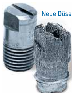
Düse mit Korrosion
