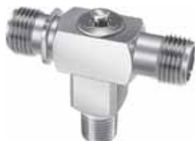
23830 Einlass: 1/4" NPT oder BSPT (AG oder IG) oder 11/16"-16 (IG) für UniJet Auslass: 11/16"-16 (AG)
