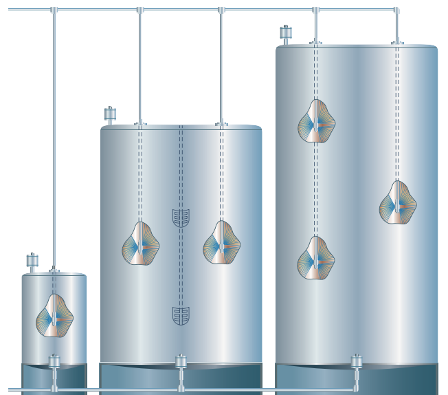
MiniRokon-Reinigungsdüsen kommen z.B. bei der Innenreinigung großer Behälter bei der Zelluloseherstellung zum Einsatz.
