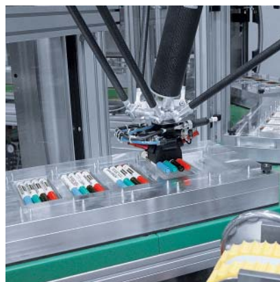
Pick-and-Place mit höchster, servogesteuerter Präzision
