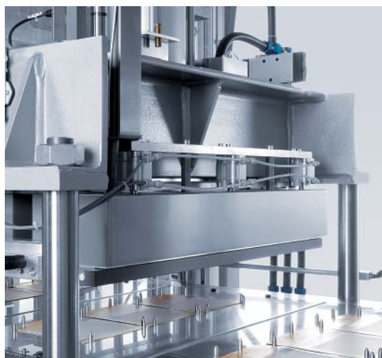
Thermische Siegelstation der Blistermaschine KBS-PL
