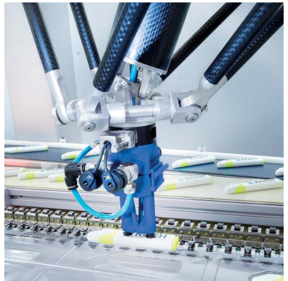
Roboter-Handling zum präzisen, sicheren Einlegen von Produkten in vorgefertigte Blister
