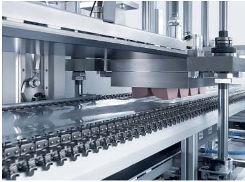
Blisterformstation der Blistermaschine KBS-KF
