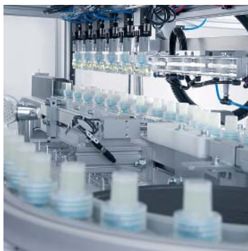
Zuführ- und Handlingsystem für ein kosmetisches Produkt
