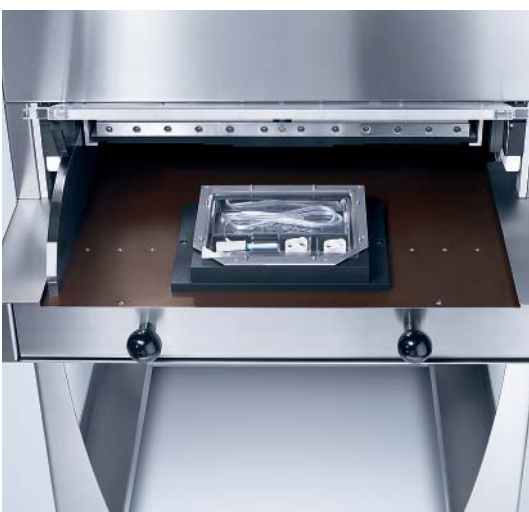
Schiebetisch mit Siegelwerkzeug und medizintechnischem Produkt
