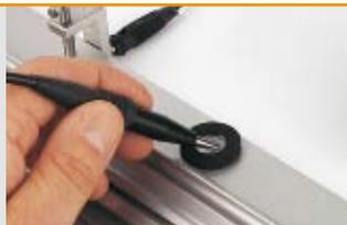
ANOTEST® YMP30-S: Nachverdichtungsprüfung anodisierter Schichten
