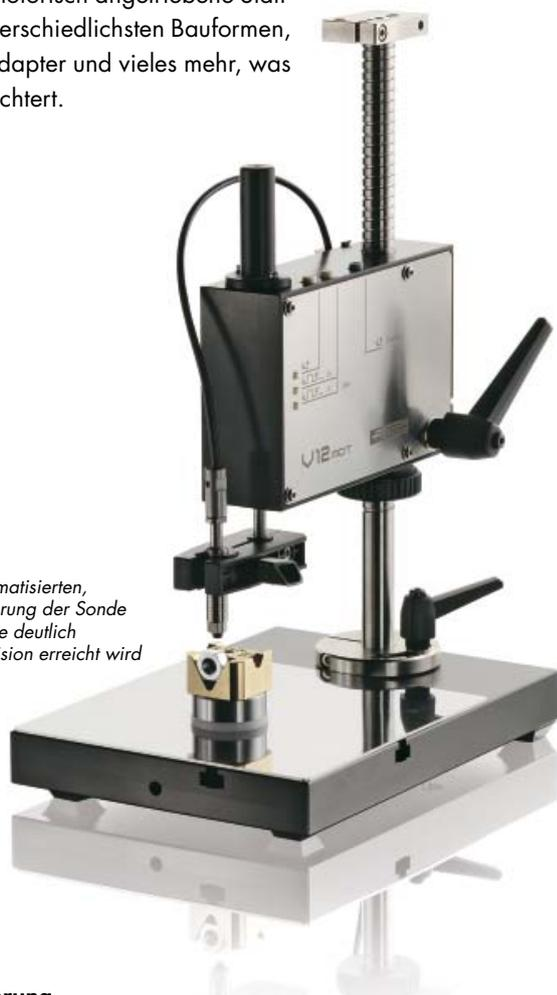
Motorisches Stativ zur automatisierten, reproduzierbaren Positionierung der Sonde auf der Probe, wodurch eine deutlich verbesserte Wiederholpräzision erreicht wird
