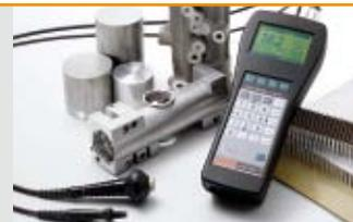
SIGMASCOPE® SMP10: Leitfähigkeitsmessung an Aluteilen
