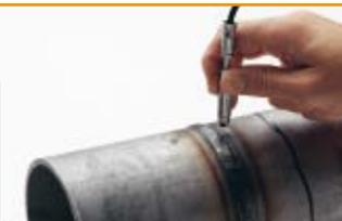
FERITSCOPE® FMP30: Ferritgehaltmessung an Schweißnähten
