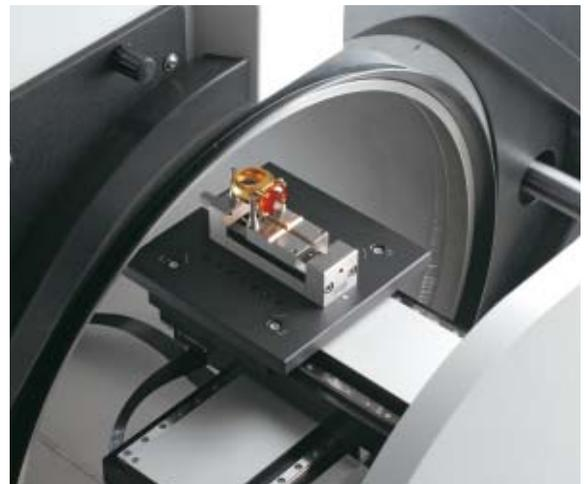
Das XUV ist das ideale Messsystem für Forschung und Entwicklung, aber auch für die Prozessqualifizierung, Qualitätssicherung und Fertigungsoptimierung bestens geeignet. Typische Einsatzgebiete sind die Analyse funktionaler Schichten in der Elektronik- und Halbleiterindustrie, z.B. dünne Aluminium- und Silizium-Beschichtungen auf Wafern. Durch die Messung im Vakuum können für diese Schichten Wiederholpräzisionen von wenigen Nanometern erreicht werden.
