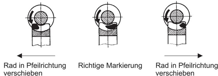
Durch Kontrolle der Lage des Tragbildes im eingebauten Zustand läßt sich erkennen, ob ein Einbaufehler bezüglich der axialen Stellung des Schneckenrades vorliegt. Das Tragbild sollte möglichst zur Auslaufseite tendieren. Bei wechselnder Drehrichtung (Reversierbetrieb) sollte das Tragbild zur Mitte tendieren.
