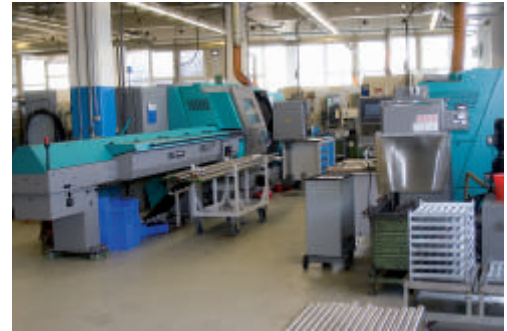
Stangendrehaufomat Index G160 Drehen und Fräsen mit bis zu 7 Achsen, größte Werkstückabmessung Ø65 x 430
