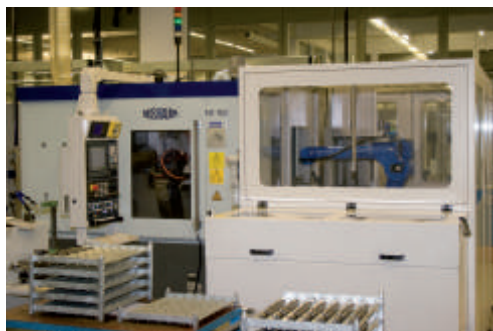
Wälzschleifmaschine Reishauer RZ 150 Schleifen von Außenverzahnung an Wellen und Rädern, größte Werkstückabmessung Ø145 x 400 / bis Modul 3
