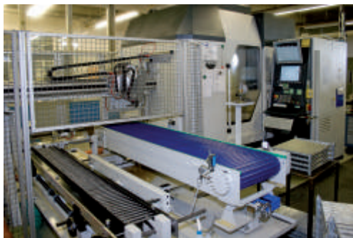
Profilsleifmaschine Haas Multigrind HT-Direkt Schleifen von Schneckenverzahnungen und Gewinden, größte Werkstückabmessung Ø50 x 380 / bis Modul 5
