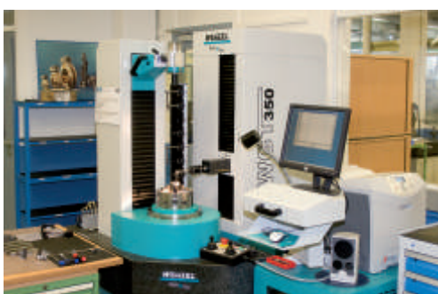
Verzahnungsmessgerät Wenzel WGT 350 Vollautomatische Vermessung von Verzahnungen, größte Werkstückabmessung Ø350 x 650 / bis Modul 15
