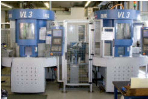
Vertikales Einspindel – Drehzentrum EMAG VL3 Drehen und Fräsen von Futterteilen mit bis zu 3 Achsen, größte Werkstückabmessung Ø130 x 110
