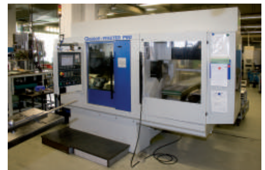
CNC-Wälzfräsmaschine Gleason Pfauter P90 Fräsen von Verzahnungen an Wellen und Rädern, größte Werkstückabmessung Ø100 x 400 / bis Modul 5
