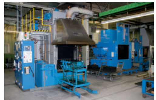
Mehrzweckkammerofen IVA / MKE 1 Härten / Einsatzhärten / Karbonitrieren / Aufkohlen Chargenabmessung 1000 x 600 x 600 / bis 600kg
