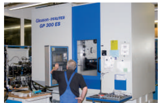
Wälzstoßmaschine Gleason-Pfauter GP 300 ES Stoßen von Verzahnungen bis zu einer Schräge von 45°, größte Werkstückabmessung Ø300 / Verzahnungsbreite 100 / bis Modul 6
