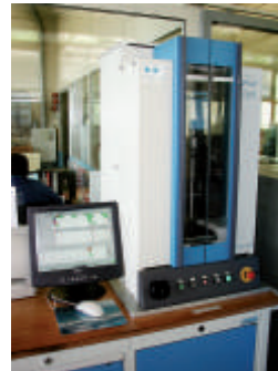
Berührungsloses Wellenmessgerät Hommel Opticline Contour 410 Für Rotationsmessungen der Außenkonturen, größte Werkstückabmessung Ø150 x 400
