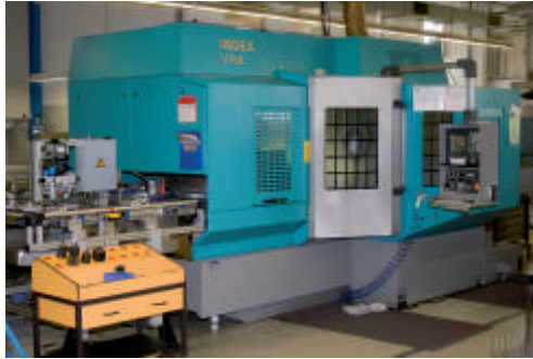
Drehzentrum Index V 160 Drehen und Fräsen von Futterteilen mit bis zu 10 Achsen, größte Werkstückabmessung Ø200 x 140
