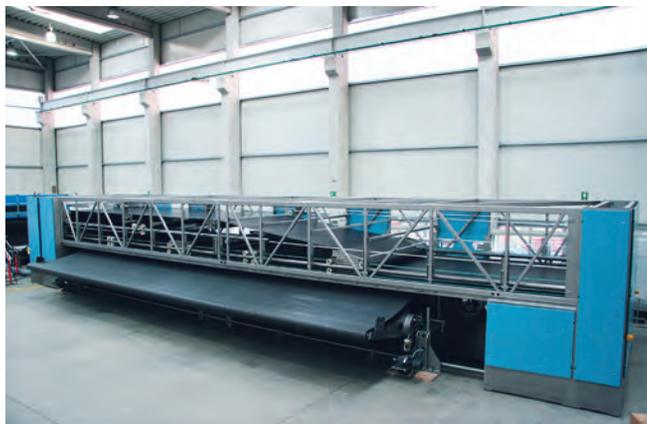
▲ DILO-Layer Typ DLP für Papiermaschinenfilze in 14,5 m Arbeitsbreite
