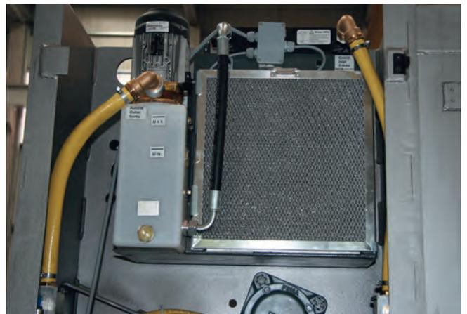
▲ Kühleinheit der Torquemotoren
