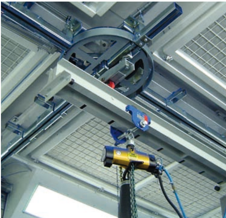
Kombination aus Drehweiche und Gerätekran mit Hebezeug
