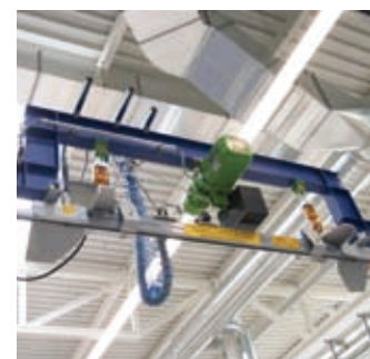
Hub- / Senkstationen zur Niveaüberbrückung mittels Synchronkettenzug (z.B. Tauchbäder oder Auf- und Abhängen von Teilen)
