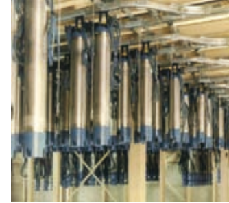
Handhängebahn mit Pufferzone in einer Fabrik für Tauchpumpen
