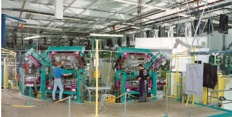
Rotierende Spritzgussanlage der Firma Krauss-Maffei Kunststofftechnik (München); Einsatz in der Firma Johnson Controls Interiors (Lüneburg)
