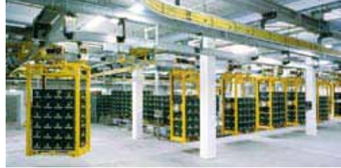
SingleFlexLine 0811 an einer Elektrohängebahn in einer Brauerei
