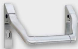
Panik-Stangengriff Edelstahl matt gebürstet, komplette Ausführung in widerstandsfähigem Edelstahl, verwendbar für max. 1300 mm Türbreite, rechts/links verwendbar, kombinierbar mit einem Außenbeschlag gemäß DIN 18273
