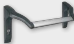
Panik-Stangengriff Aluminium schwarz-matt, mit Stahlunterkonstruktion, Griffrohr Aluminium eloxiert EV 1, verwendbar für max.1300 mm Türbreite, rechts/links verwendbar, kombinierbar mit einem Außenbeschlag gemäß DIN 18273
