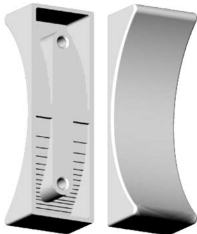
Sattel-Distanzhülse 90x30 mm, R 54,5 mm mit 2 Gewindegängen M5* Saddle washer 90x30 mm, R 54.5 mm with 2 threads M5* Rondelle de selle 90x30 mm R 54,5 mm avec 2 filetages M5*
