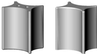
Sattel-Distanzhülse 24x19x15,5 mm mit 2 Bohrungen als Verdrehsicherung* Saddle washer 24x19x15.5 mm with 2 blind holes d 2.5 mm for location* Rondelle de selle 24x19x15,5 mm avec 2 trous d 2,5 mm pour positionnement*
