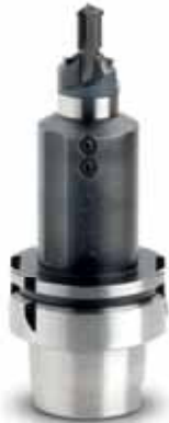
JEL® Sonderwerkzeug VABOS-K mit BGF M14x1,25, PKD bestückt. Drei Arbeitsgänge mit nur einem Werkzeug – für vorgegossene Bohrung auf Kern- lochmaß aufbohren, Einbringen von 90° und Plansenkung Ø 22 mm, Fräsen des Gewindes M14x1,25.
