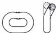
Ketten mit örtlichen Schäden wie gebogenen Gliedern, Rissen oder Kerben an den Gliedern außer Betrieb nehmen.
