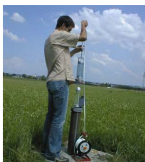
KLL mit mechanischem Probenheber
