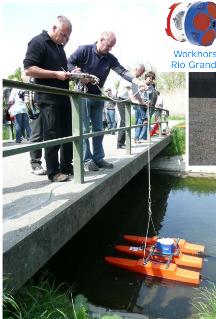
Messung mit WorkHorse an Trimaran
