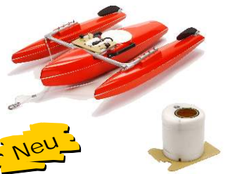
Neu RiverRay mit phasengesteuertem Sensorfeld
