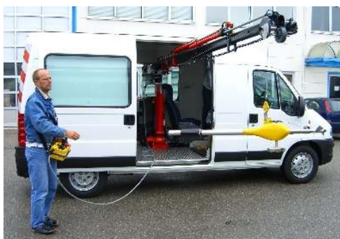
Messfahrzeug mit Kran und Flügelausrüstung zur mobilen Durchflussmessung
