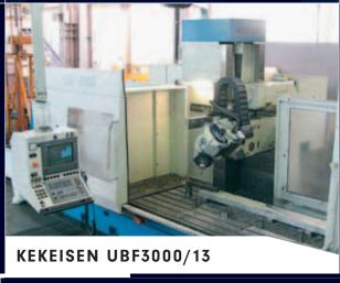
x-Achse 3 000 mm y-Achse 1250 mm
