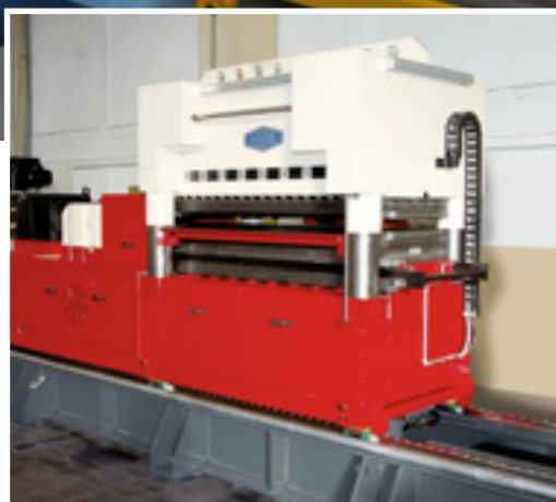
GEORG-Hochleistungsrichtmaschine RM 55 x 1600 für eine Pressenlinie im Automotivebereich
