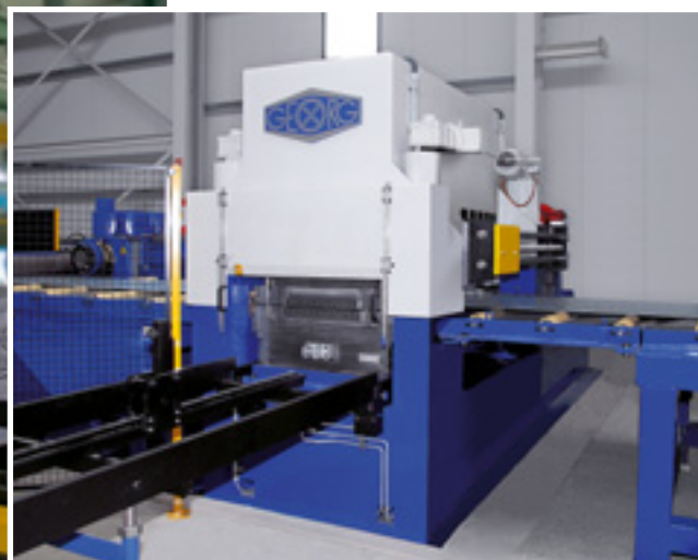
GEORG-Hochleistungsrichtmaschine RM 65 x 1600 in einer GEORG-Querteillinie für hochfeste Bänder
