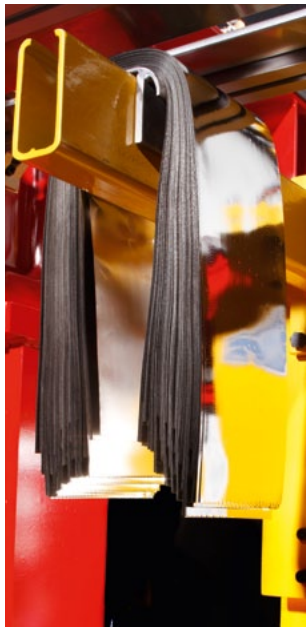
Querteilanlage für amorphes Material (AMC)
