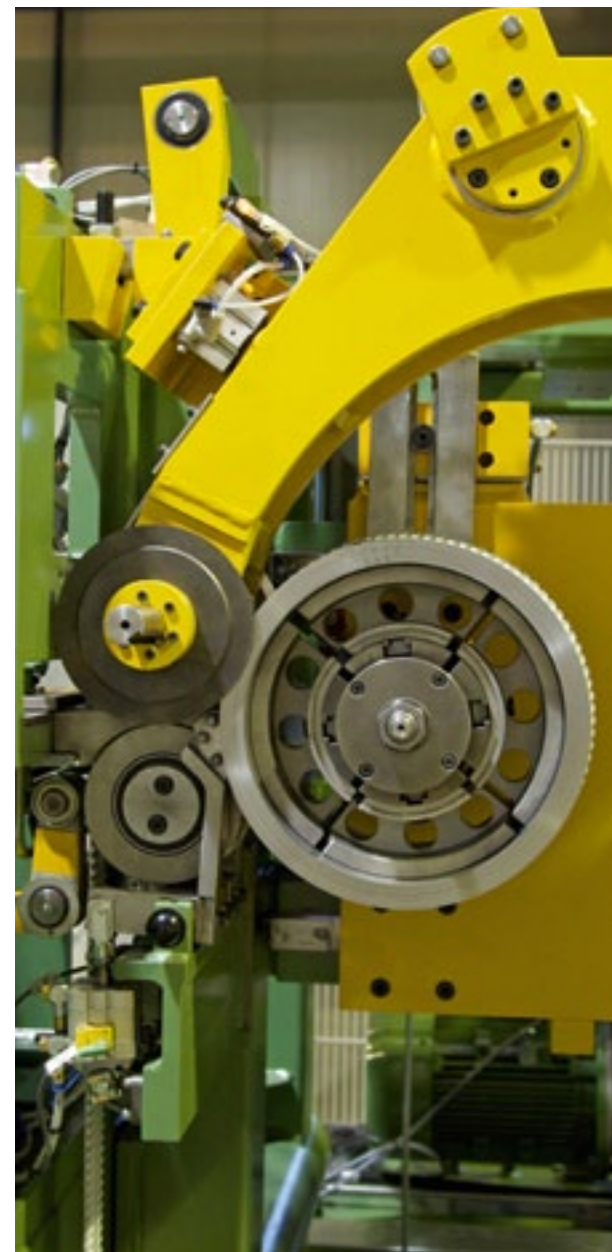
Wickelkernanlage mit Exzentrerschere (SWA)
