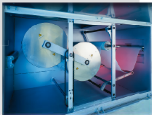
Walzenvorheizung VHW 91/2 (r.)
