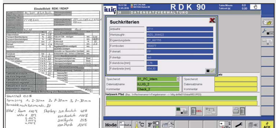
Bild 2: ThermoLineControl – Die traditionelle „Zetteldokumentation“ ist endgültig abgelöst: Alle in der Datensatzverwaltung gespeicherten Daten lassen sich auch gezielt nach unterschiedlichsten Kriterien suchen und schnell für den erneuten Produktionsstart nutzen.
