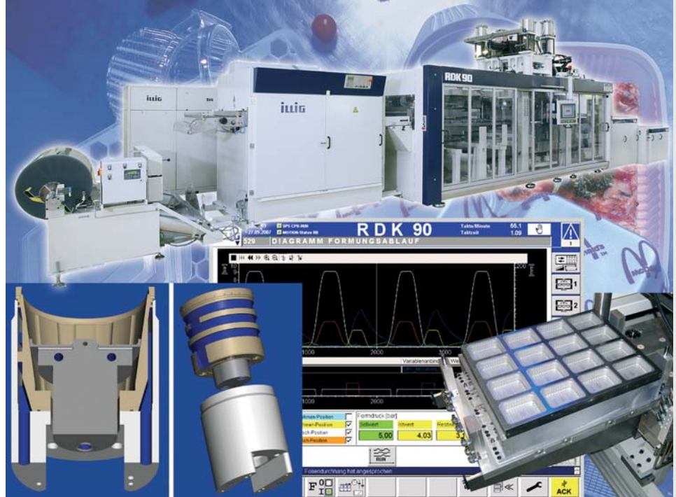
Bild 1: Hochleistungs-Produktionslinie mit dem Druckluftformautomaten RDK 90: Wie hier beim 16-fach-Schalenwerkzeug erleichtert eine Werkzeugwechsellösung den schnellen Format- und Werkzeugwechsel – und die neue Mantelkühlung (unten links) ermöglicht durch großflächiges, konturnahes Kühlen eine hohe Qualität der Formteile bei gleichzeitig hohen Taktzahlen.
