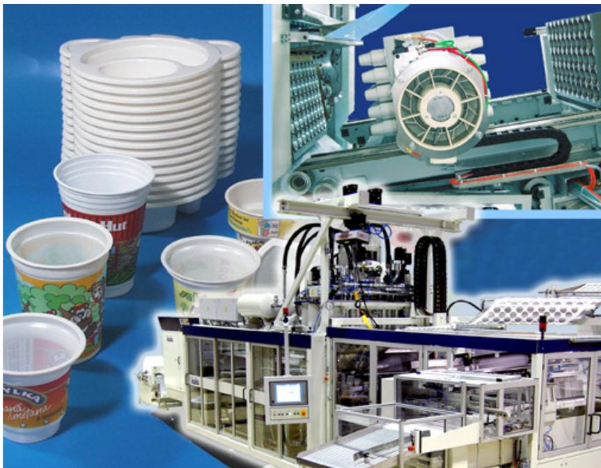
Thermoformer der Baureihe RDM-K, konzipiert für becherförmige Produkte unterschiedlichster Art: Werkzeugtechnik der 3. Generation mit reduziertem Formluftvolumen und dynamischem Formdruckaufbau führt zu hohen Taktzahlen bei zugleich hoher Produktqualität. Oben rechts: Schnelle Becherentnahme und produktschonende Stapelung mit dem neuen, um 180 Grad schwenkbaren Wendekopfsystem.
